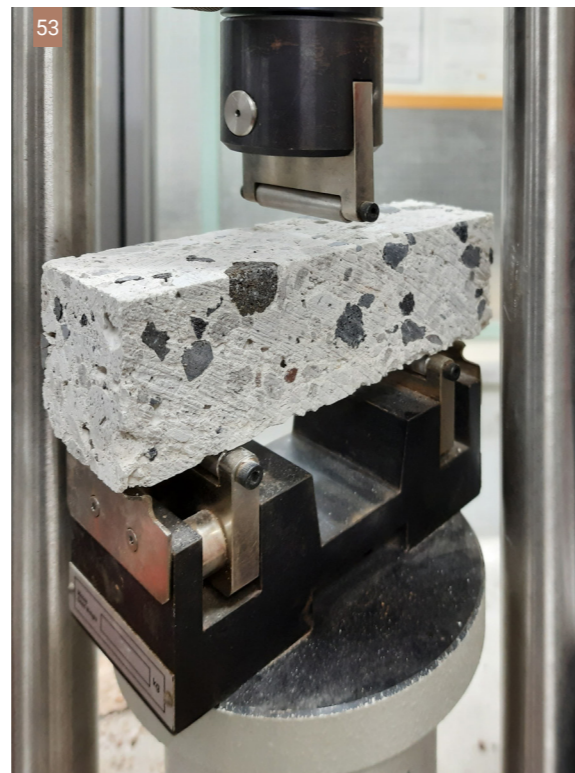
Εικ. 52, 53| Μέτρησεις θλιπτικής και καμπτικής αντοχής κισσηροδέματος από την Αγριλιά. (Εργ. ΕΜΠ, Φωτ: Π. Κωστούλας)
