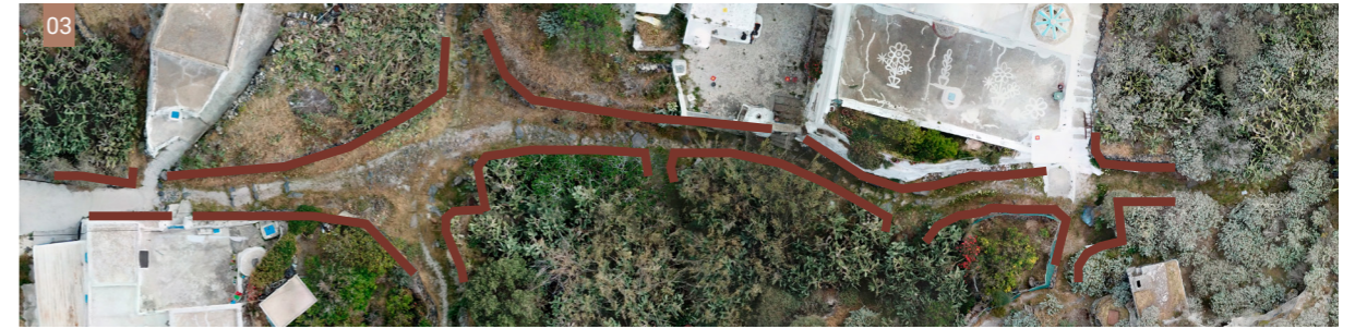
Εικόνα 3| Υπόδειξη της θέσης των αναλημματικών τοίχων σε σχέση με το κεντρικό μονοπάτι. (Ορθοφωτοχάρτης: Κ. Ευδαίμων)
