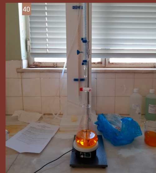
Εικ. 40| Μέτρηση οργανικού περιεχομένου δειγμάτων θηραϊκής γης. Φωτ: Ι. Ντούτση
