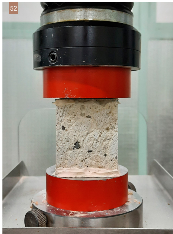
Εικ. 52, 53| Μέτρησεις θλιπτικής και καμπτικής αντοχής κισσηροδέματος από την Αγριλιά. (Εργ. ΕΜΠ, Φωτ: Π. Κωστούλας)
