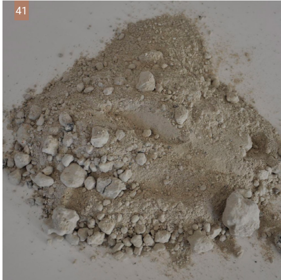
Εικ. 41| Η άσπα όπως συλλέχθηκε από διάφορες θέσεις στη Θηρασιά. (Φωτ: Ι. Ντούτση)
