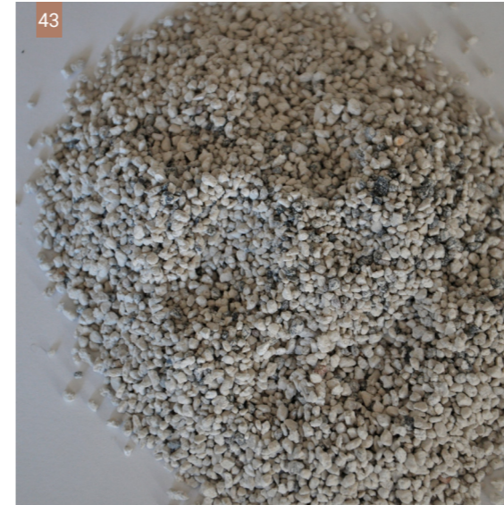
Εικ. 43| Το κλάσμα 0-3 mm της άσπας παίζει το ρόλο της άμμου στα τοπικά δομικά υλικά. (Φωτ: Ι. Ντούτση)
