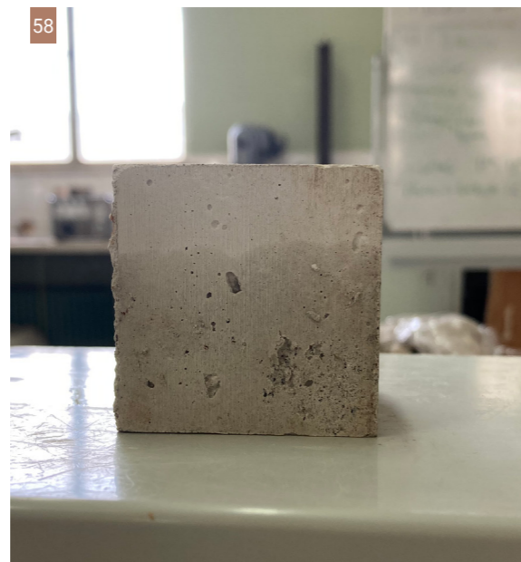
Εικ. 58| Κυβικό δοκίμιο κατά τη δοκιμή υδαταπορρόφησης. (Φωτ: Ν. Μεϊμάρογλου)
