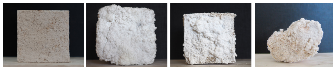
Εικ. 61-80| Η εξέλιξη στο χρόνο της ανθεκτικότητας σε άλατα για διαφορετικές συνθέσεις. (Φωτ: Χ. Κυριακόγγονας)
