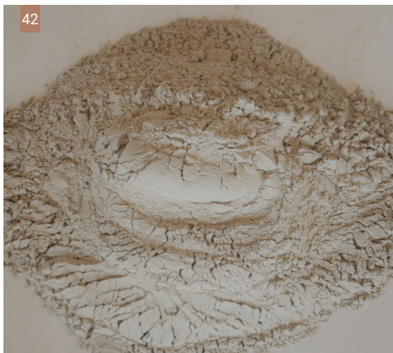
Εικ. 42| Το λεπτόκοκκο κλάσμα της άσπας κάτω από 63 μm. Αυτό το κλάσμα λειτουργεί ως το ενεργό ποζολανικό υλικό. (Φωτ: Ι. Ντούτση)
