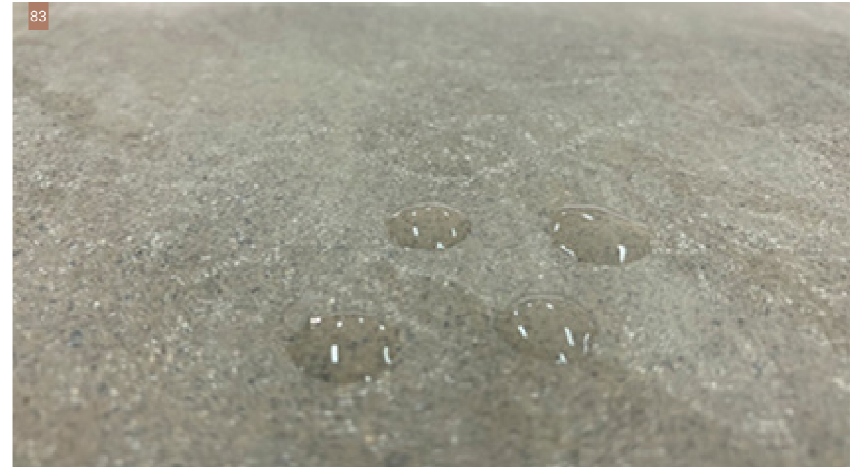
Εικ. 83| Έλεγχος του ρυθμού απορρόφησης νερού της επιφάνειας μετά την σκλήρυνση του επιχρίσματος (Φωτ: Π. Κωστούλας)
