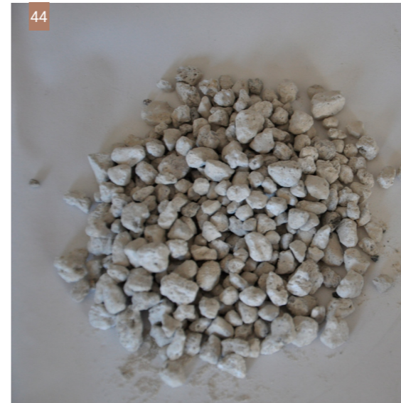
Εικ. 44| Τα κορχίδια της άσπας, τα χονδρόκοκκα αδρανή πάνω από 3 mm, πλούσια σε ελαφρόπετρες. (Φωτ: Ι. Ντούτση)
